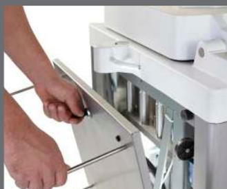
Accès de maintenance latéral avec le système de déverrouillage **Quick Access** permettant un nettoyage facile au quotidien de l'intérieur de la machine.
